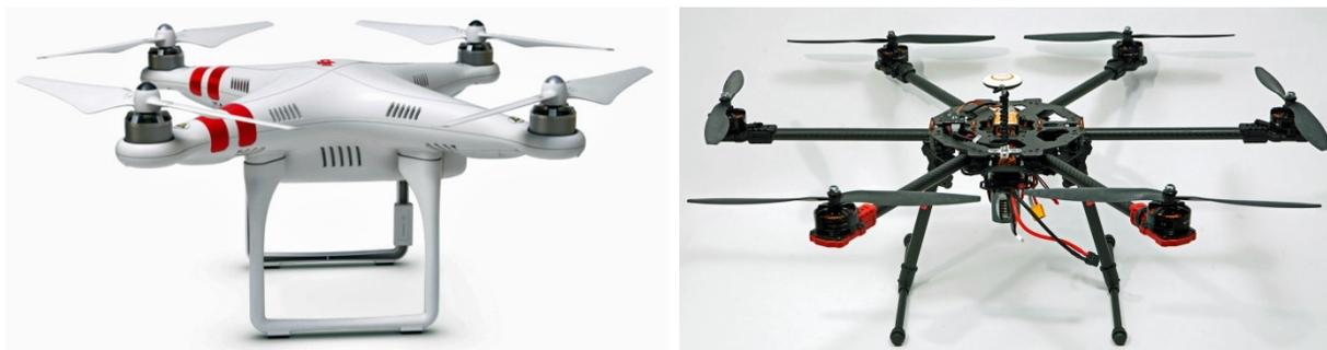
Рис. 1. Беспилотные летательные аппараты: слева – квадрокоптер DJI Phantom 2, справа – гексакоптер RC 690S Tarot 2.
